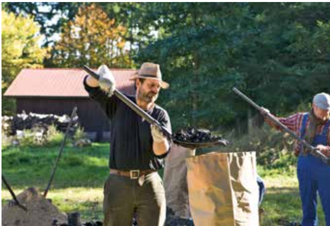
Zeit für die „Ernte“ der Kohle ist erst eine Woche nach dem Entzünden des Birkenholzes, dann, wenn der Meiler abgekühlt ist.
